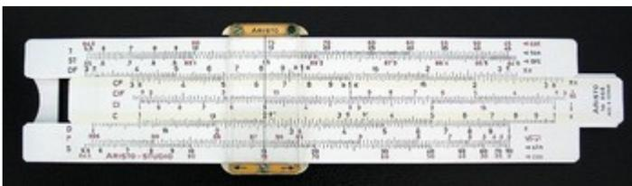
Les règles à calcul permettaient aux élèves d'effectuer des calculs compliqués (racines, logarithme...) en ajustant la réglette et le curseur central. Cet étonnant outil a été rapidement abandonné dès l'apparition des calculatrices.
